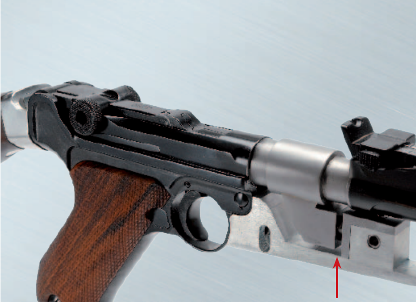
Verriegelt. Das Bild zeigt die Waffe in verriegeltem Zustand. Der Gaskolben befindet sich in eingefahrener Position (roter Pfeil).
