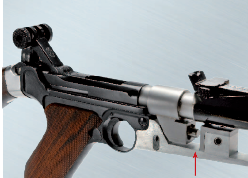
Entriegelt. Das Bild zeigt die Waffe in entriegeltem Zustand. Der Gaskolben befindet sich in ausgefahrener Position (roter Pfeil).
