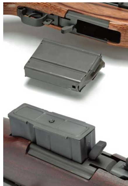
Szczegóły przeróbki magazynka wewnętrznego na wymienny
