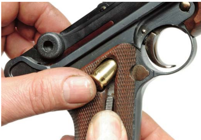
Jedynym wyjściem, by bez poważnej ingerencji w szkielet pomieścić w chwycie grube naboje .45 ACP była rezygnacja z wymiennego magazynka i zmiana sposobu ładowania
