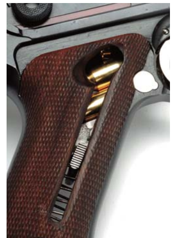
Obustronne wycięcia w rękojeści czterdziestki piątki nie tylko dają dostęp do „guziczków” donośnika, ale i pozwalają błyskawicznie ocenić stan załadowania
